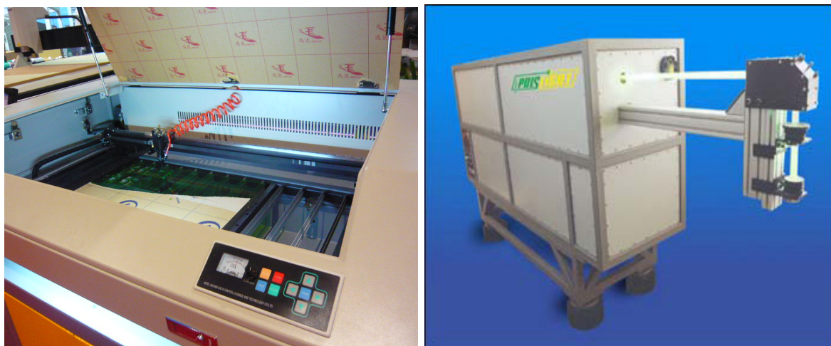
Фиг. 1. Общ вид на лазерни технологични системи за рязане с \text{CO}_2 -лазер и лазер на \text{CuBr}
